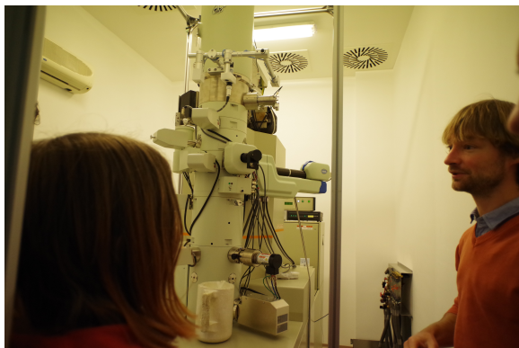
Obr. 34: Transmisní elektronový mikroskop
